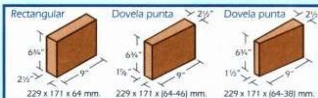
Las piezas de la serie 229 x 171 x 64 mm, [9 x 6 1/2 x 2 1/2"], 229 x 171 x 76 mm, [9 x 6 1/2 x 3"] Se usan para romper juntas y obtener mejores construcciones refractarias.
